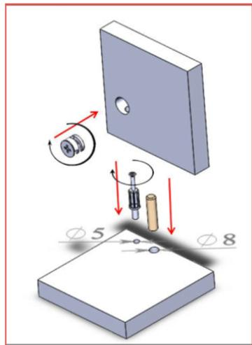
при соединении панелей используем эксцентриковую стяжку и шканты.
